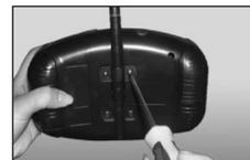
Die Schelle über der Antenne mit einem Kreuzschlitz-Schraubendreher lösen.
