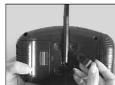
Schelle auflegen und festschrauben. Durch die Drehung befindet sich die Drehzahlsteuerung jetzt auf der rechten Seite.
