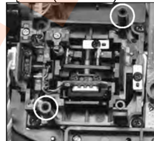
Przykręć obudowę do drążka znajdującego się po lewej stronie.
